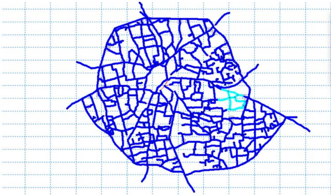
图 1.7-1 杭嘉湖地区一维河网水动力模型概化图
